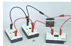
Si on dévise une lampe, l'autre continue à briller.
