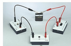
Si une lampe est dévissée, l'autre ne brille plus.
